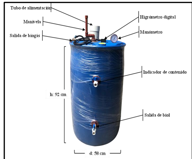
Figura 2. Modelo de biodigestor tipo batch.
